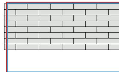
如果第一排最後一個面板的切割太小（小於300mm），則將一個新的板塊切成兩半，並使用該半塊地板開始下一行。
