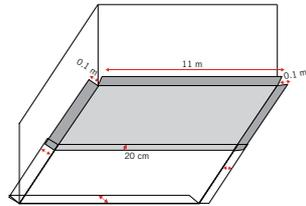
將防潮膜鋪在底層地板上並展開，確保沿長度方向有預留100毫米，兩端折疊在牆上。
